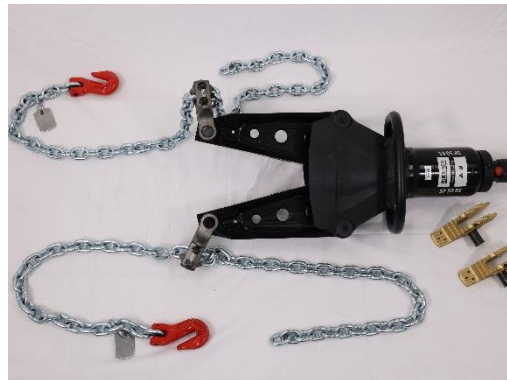
14.1-2 mit eingehängtem Kettensatz
