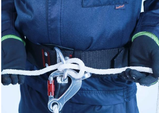
17.2.2-3 Halbmastwurfsicherung in D-Öse des Feuerwehr-Haltegurtes eingelegt
