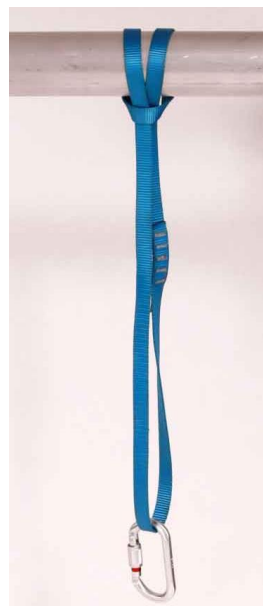
17.2.1-3 doppelter Ankerstich mit einer Bandschlinge
