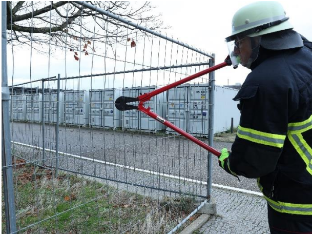
15.2-1 Bolzenschneider zum Trennen eines Zaunes
