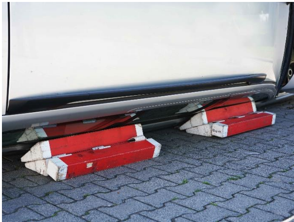
16.2-2 Unterbau mit Schlauchbrücken
