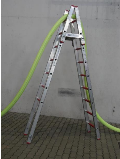
4.6-3 Einsatz der Bockleiter als Schlauchüberführung
