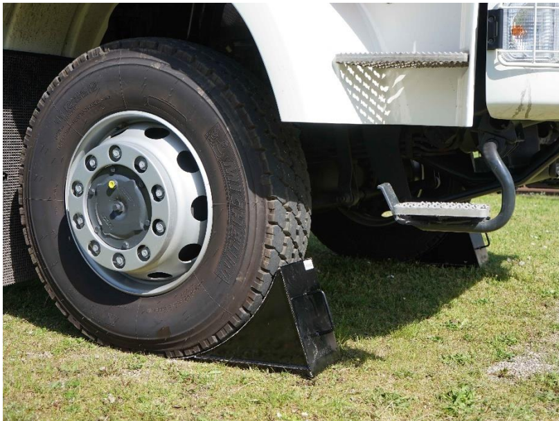
13.3-1 Auffahrkeile auf verdichtetem Untergrund
