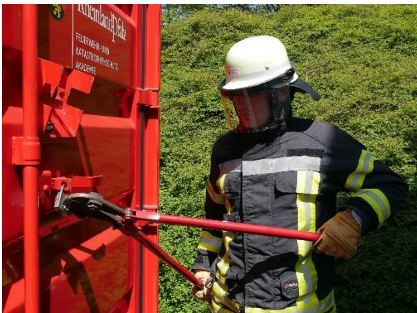
15.2-2 Bolzenschneider zum Öffnen eines Vorhängeschlosses
