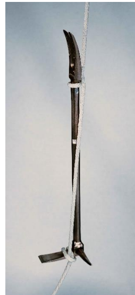
17.3-3 Aufziehen eines multifunktionalen Hebel-/Brechwerkzeuges
