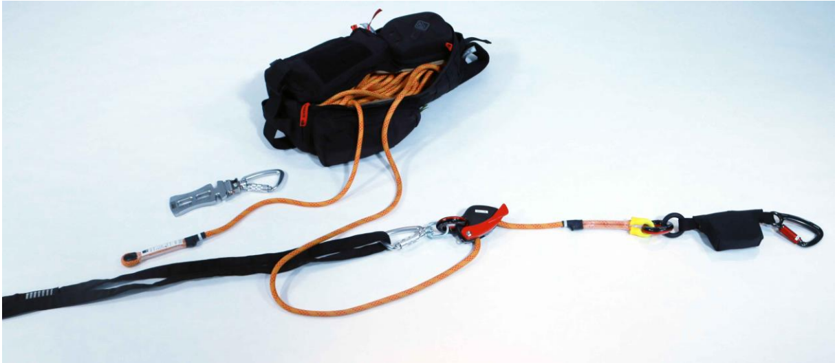
17.1-5 Kernmantelseil in einem geschlossenen Sicherungs- und Rettungssystem
