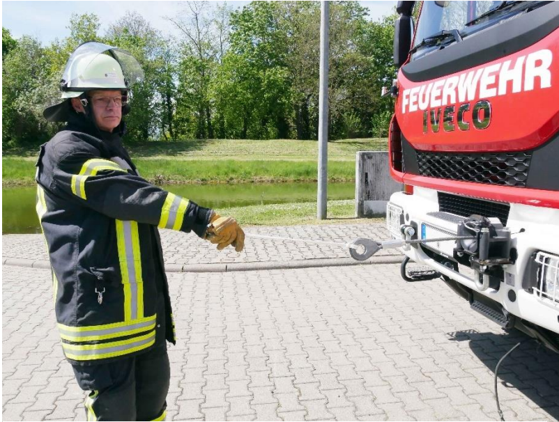
13.3-2 Aufspulen des Zugseils mit Halteschlaufe
