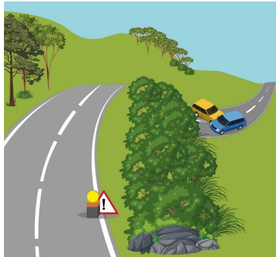
21.1-3 Vorwarnung auf eine Einsatzstelle hinter einer Kuppe
