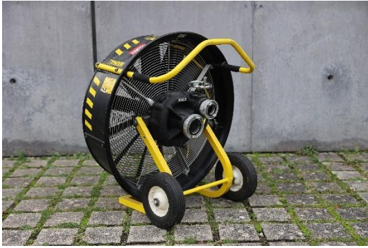
11.1-3 Lüfter mit Wasserantrieb
