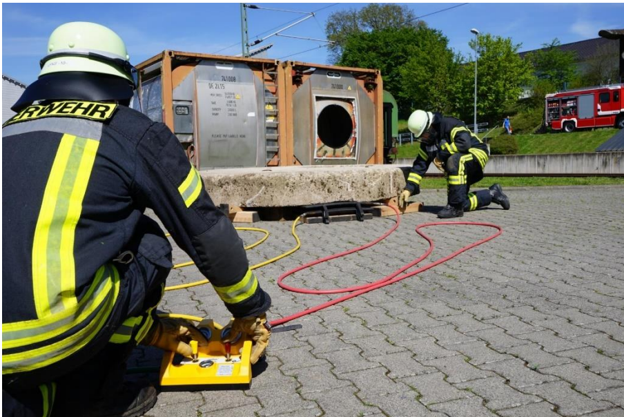
12.2.2-2 Hebekissensystem über 1 Bar beim Heben einer Last
