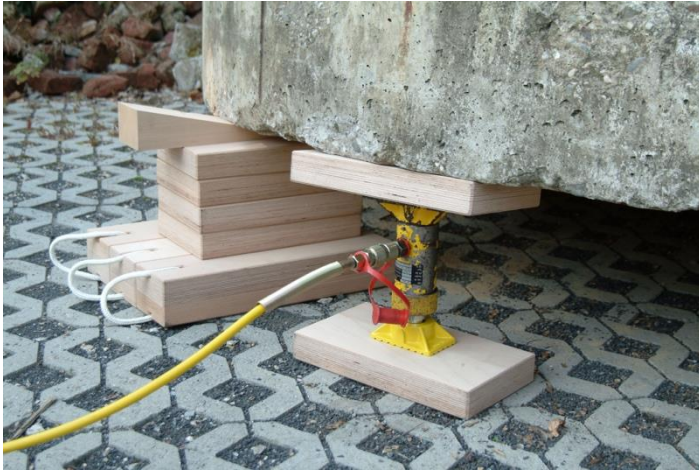
12.4-2 Hydraulischer Hebesatz beim Heben einer Last
