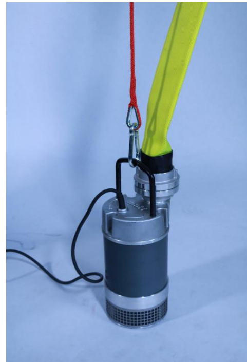
6.6-2 Sicherung mit einem Feuerwehrkarabiner
