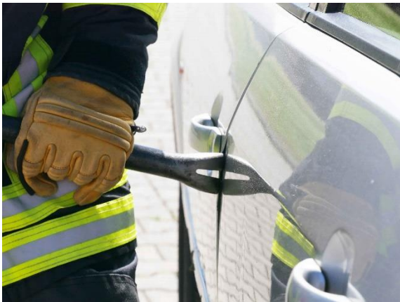
8.1-1 Spalt an einer Fahrzeugtür mit der Brechstange schaffen
