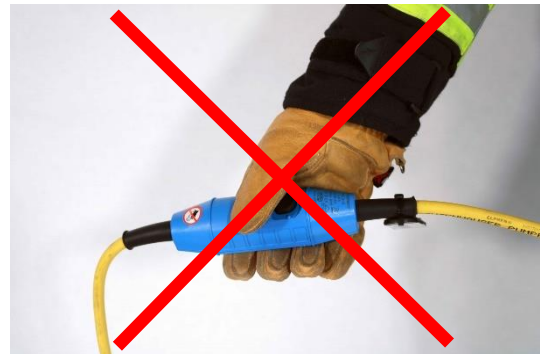
9.4-3 Personenschutzschalter dürfen nicht mit Handschuhen aktiviert werden.
