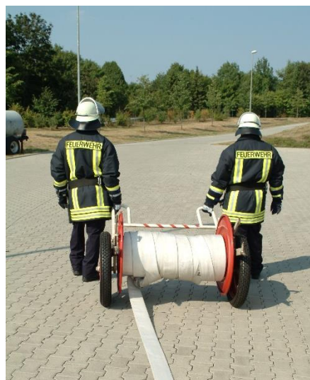
4.4-4 Auslegen eines Schlauches mit der Zwei-Personen-Schlauchhaspel
