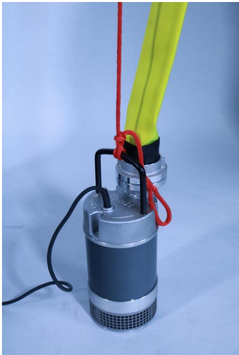
6.6-1 Sicherung mit einem gesicherten Mastwurf
