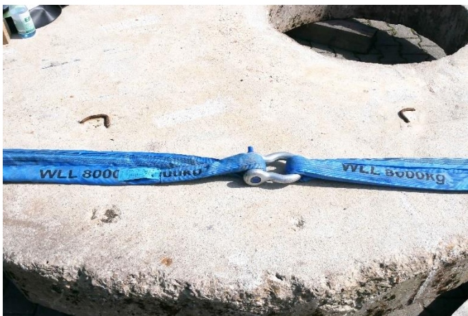
13.1.4-2 Verbinden von Rundschlingen mit einem geschweißten Schäkel
