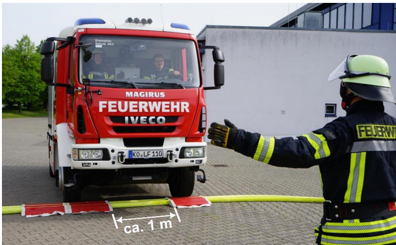
4.7-1 Befahren von Schlauchbrücken
