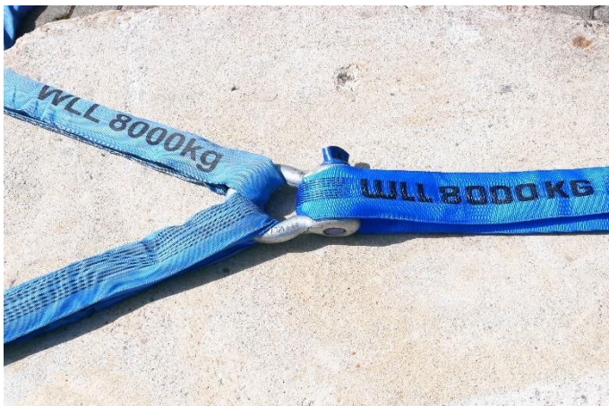
13.1.4-3 Zusammenführen von Rundschlingen mit geschweißtem Schäkel
