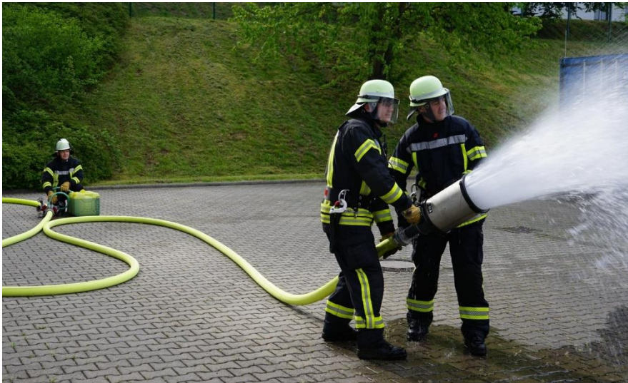
5.3.1-1 Einsatz eines Trupps mit Kombinationsschaumstrahlrohr
