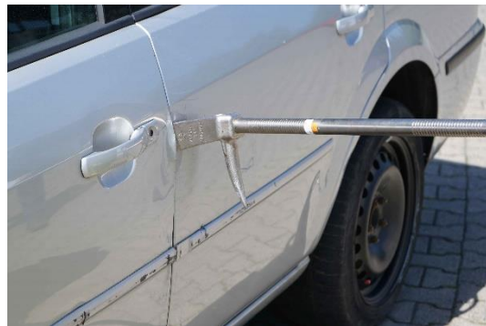
8.2-2 Spalt an einer Fahrzeugtür mit multifunktionalem Hebel-Brechwerkzeug schaffen
