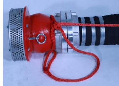
6.1-6 Sicherung des Saugkorbes mittels gesicherten Mastwurfes
