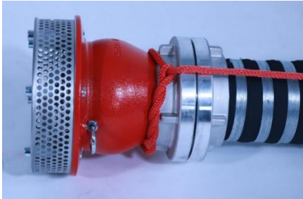
6.1-5 Sicherung des Saugkorbes mittels Zimmermannsschlages
