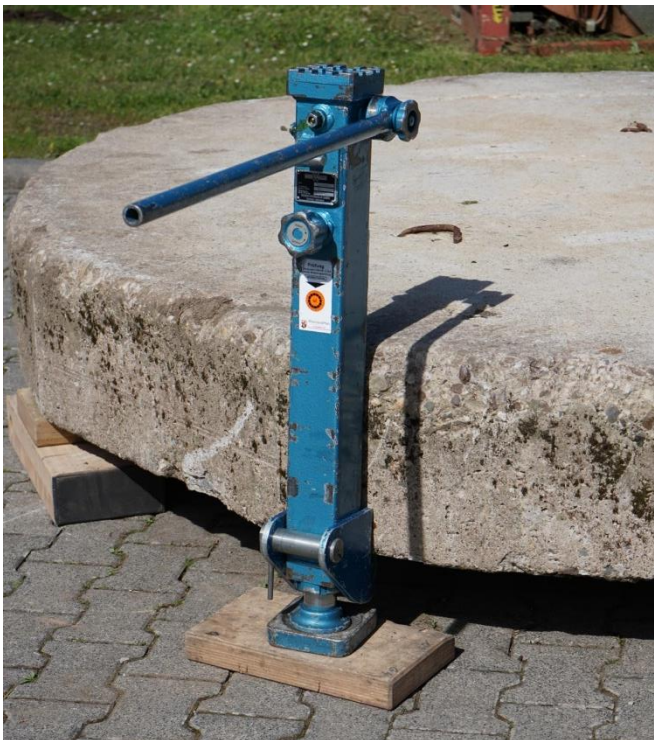
12.3-2 Hydraulische Winde beim Anheben einer Last
