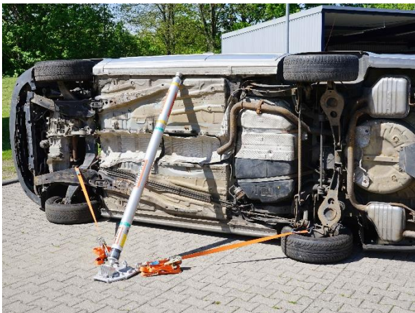
16.3-1 Abstützen mit Abstützsystem
