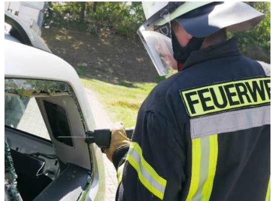
15.3-2 Elektrische Säbelsäge im Einsatz
