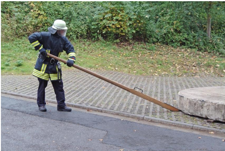
12.1-1 Hebebaum beim Anheben einer Last
