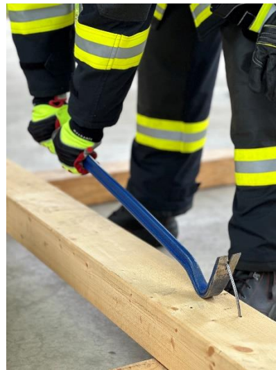
8.3-2 Ziehen von Nägeln mit dem Nageleisen
