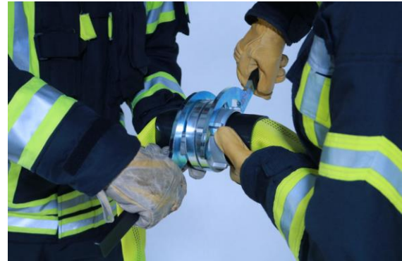
4.5-2 Kuppeln der Schlauchkupplungen mit Kupplungsschlüsseln
