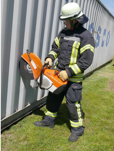
15.4-2 Verbrennungsmotor betriebene Trennschleifmaschine
