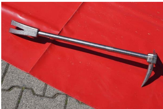
8.2-5 richtig abgelegtes multifunktionales Hebel-Brechwerkzeug
