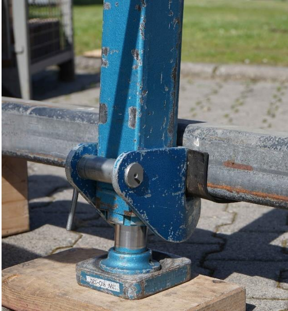
12.3-3 Hydraulische Winde mit rutschhemmender Unterlage an der Hebeklaue
